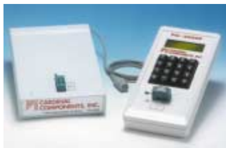
Bild 2 Programmiergeräte der PG-2000-Serien von Cardinal zum Programmieren von Oszillator-Blanks
